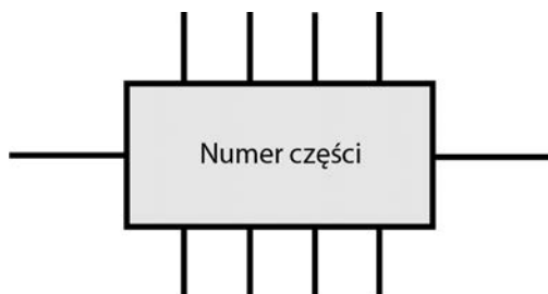
Rysunek 3.45. Ogólny symbol układu scalonego
